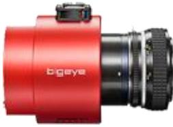
Bigeye P-629B NIR 近红外工业相机是德国 AVT 公司生产的一款 600 万像素高分辨率制冷工业相机，采用质量优越的低噪声 OnSemi KAF-6303E CCD 图像传感器，GigE 千兆网接口。可选配 Peltier 半导体制冷（温度可稳定与+5℃），即使在曝光时间较长的情况下，也能获取高质量的图像。
